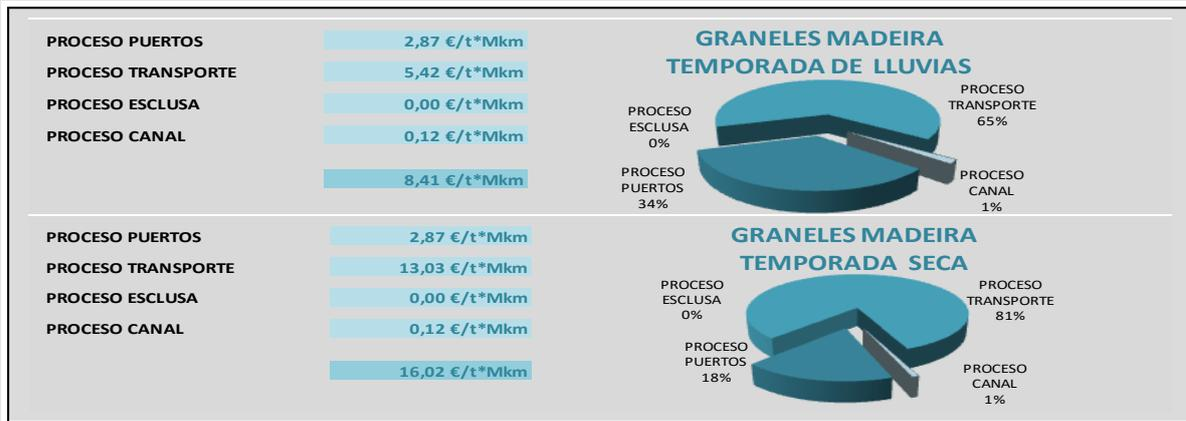
**Fig. 2 – Resultados modelo estimación de costes. Costes totales y distribución por Proceso. Transporte de graneles sólidos en el río Madeira.**
